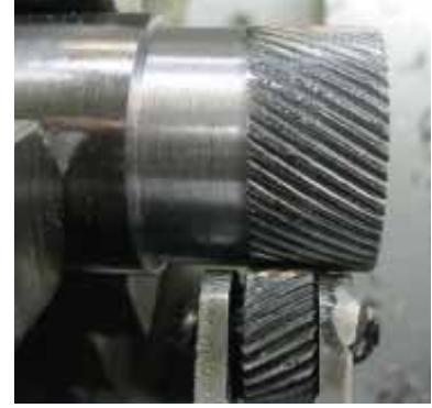
شکل ۹-۱۳ بعد از انجام اجزنی قطر قطعه افزایش می یابد
